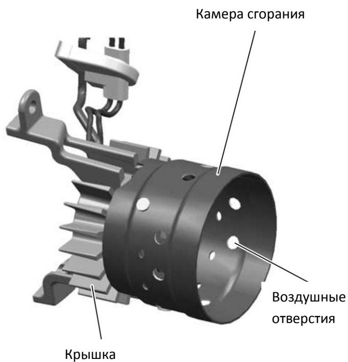
Рис. 5-5 Визуальный контроль, горелка в сборе
